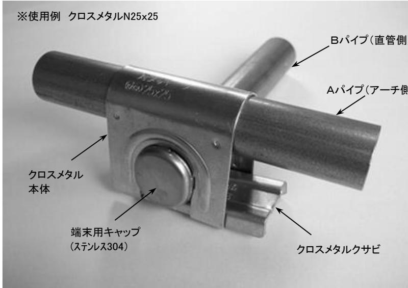
パイプハウス端末部(妻面)のアーチパイプと直管パイプを段違いのTバンドとしても使えるので、小径(パイプ直径25.4mm位までのハウスなら従来のTバンド(ネジ式)で施工できますが大径のハウスはこのタイプのT字金具が最適です
